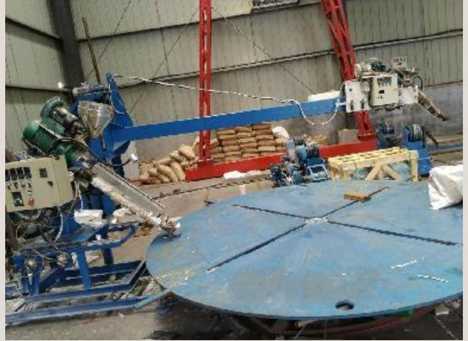
安装 LEISTER 热风器的塑管焊接机
