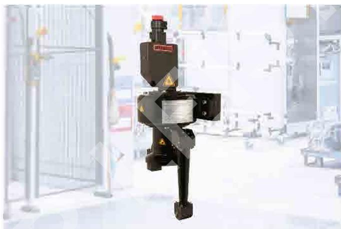
Rotation Optic用于旋转对称部件的顺序焊接。它是专门用光纤激光器操作的，其激光束可以通过一个M型DOE调整成不同的直径。一个带有空心轴的同步电动机和增量式位置测量系统被集成到光学器件中，并使悬臂(转子)围绕组件移动。激光束通过转子末端的可调镜面向中心偏转。
