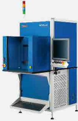
NOVOLAS™ WS-AT RTT激光焊接系统可与旋转分度台 (RTT) 一起使用。RTT是一个可选的模块, 由于周期时间较长, 可以提高吞吐量和效率。
