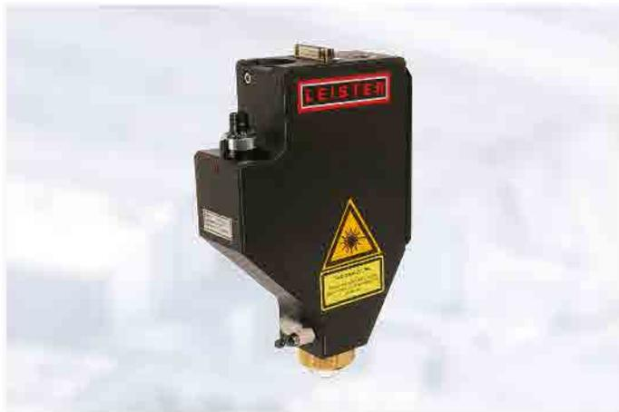
有了Globo Optic, 不需要复杂的夹具技术就可以进行二维甚至三维焊接。含气玻璃球可使激光辐射聚焦, 也可提供机械夹持力。当滚珠在部件上滚动时, 它完全和局部地压在连接平面上。这意味着激光辐射只照射到有接触压力的地方。
