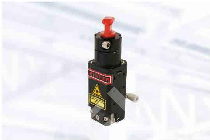
滚筒镜头不需要额外的夹持技术。在滚筒镜头中, 线性激光束通过玻璃滚筒引导。玻璃滚筒既是压力工具, 也是最后一个光学元件。滚筒的两侧有支撑, 可以产生约3-6.7毫米/ 的焊缝宽度。由于滚子的摆式轴承, 轴向的微小不规则可以得到补偿。
