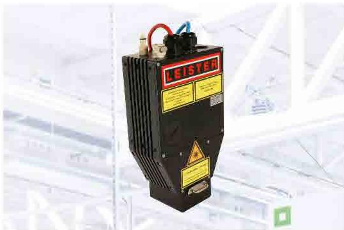
LineBeam是面罩焊接的理想光源。它产生的线几乎是恒定的功率密度分布，从而产生一致的焊接模式。LineBeam是一个由二极管激光器和直接耦合光学器件组成的紧凑型系统。系统的光学元件可以根据不同的线路长度进行调整。
