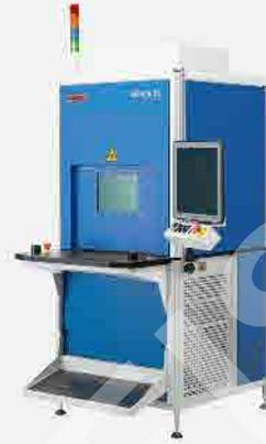
**NOVOLAS™ WS-AT**是模块化的通用激光焊接系统。它可配备多种功能的半自动工作站,并且能为客户提供定制化的应用和工艺流程。
