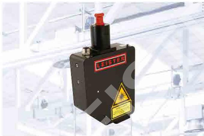
Spot Optic 将激光束聚焦于一点，主要用于轮廓焊接。所用聚焦透镜的焦距决定了焊点直径，而焊点直径又决定了焊缝的宽度。因此，激光束可以通过更换光学元件来适应塑料焊接的个性化要求。此外，光学器件还配备了监测电子装置，用于测量激光功率、监测光纤连接器和测量焊接温度。
