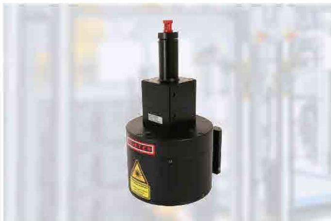
使用Radial Optic, 无需额外的夹持技术就可以实现无旋转激光焊接。径向焊接适用于自身难以旋转的旋转对称部件。激光辐射通过锥形镜偏转到组件的圆周上。这允许同时焊接直径达 $\phi 68$ 毫米/2.7英寸的部件。其优点是周期短, 产量高。
